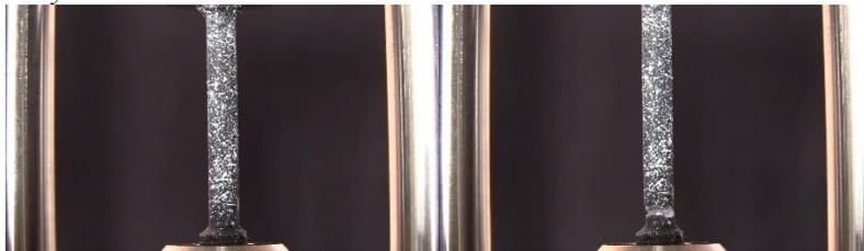
Nota. Imagen de elaboración propia las cuales muestran la comparativa de el punto de ruptura respecto a la carga máxima que soporta el material.
