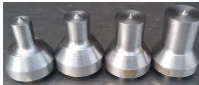
La fabricación de punzones, figura 3, se realizó en función de las especificaciones propias del equipo utilizado en planta y bajo los procesos de maquinado correspondiente como torneado, careado y desbastado de material.
