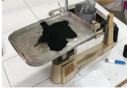
La preparación del fundente, figura 2 que se utilizó en el proceso de cementación se realizó en función del espacio de la caja de cementación por las razones expuestas en el punto anterior. Se utilizó carbón mineral triturado, pasado por las cribas 50 y 250 para reducir el tamaño de la partícula.
