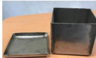
Las dimensiones del prototipo de la caja de cementación se calcularon en función de la cavidad del horno -mufla- en un volumen de 87 X 92 X 92 mm, en lámina al Ni-Cr calibre 20 serie 316, se consideró la parte superior como tapa o acceso de material carburante y piezas de trabajo. Figura 1
