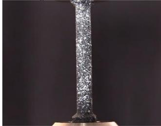
Nota. Imagen de elaboración propia mostrando como la cámara visualiza a la probeta con su técnica de moteado ideal .
