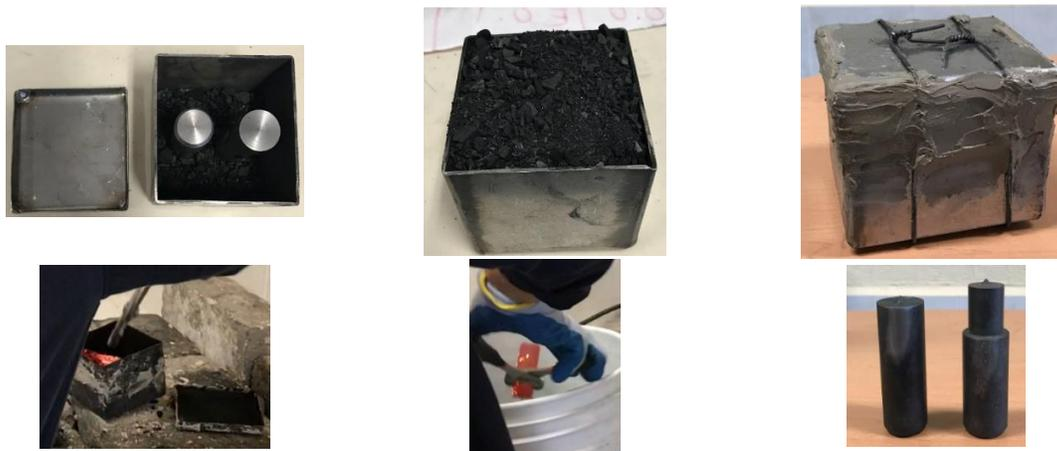
Los punzones utilizados para el proceso de cementado fueron aquellos fabricados con acero 8620. Estas piezas se colocaron en el prototipo de la caja de cementación, una vez colocadas las piezas se cubrieron con el carbón vegetal como mínimo entre 20 a 30 mm a la totalidad de las piezas fabricadas.
