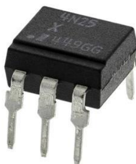
Figura 5. Optoacoplador 4N25. Fuente: Electrónica LED semiconductor. (2016).
