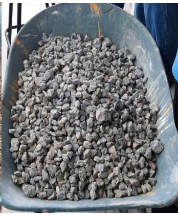
d) agregado grueso a partir de concreto reciclado
